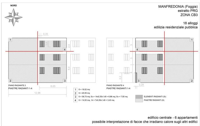
La piantina in alto espone una possibile interpretazione dei piani radianti. Riscontro da subito che solamente due (il piano 2 e 4) si dimostrano interessanti sotto il profilo delle possibili emissioni di calore da parte dell'edificio centrale nei confronti di quelli adiacenti.
